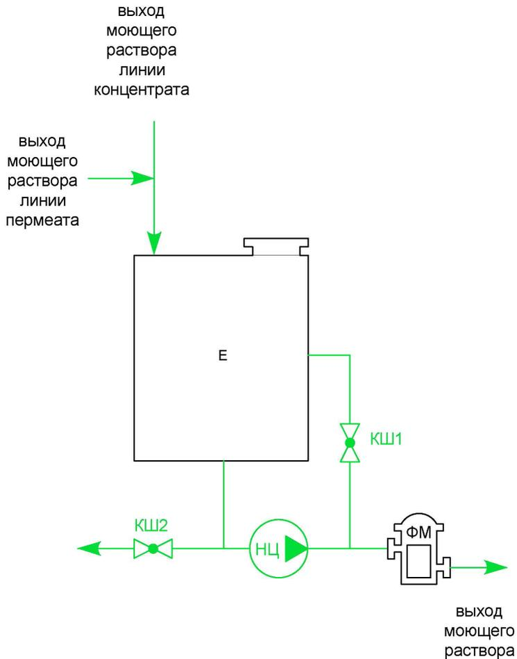
Е – емкость, НЦ – насос центробежный, КШ – кран шаровый, ФМ – фильтр механический.
