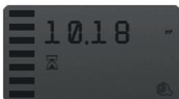
10. Нажмите ▢ для выхода из режима установки параметров. Экран перейдет в рабочий режим, если в течение одной минуты не было никаких действий, то система автоматически перейдет в режим блокировки клавиш и на экране появится символ ⓧ
