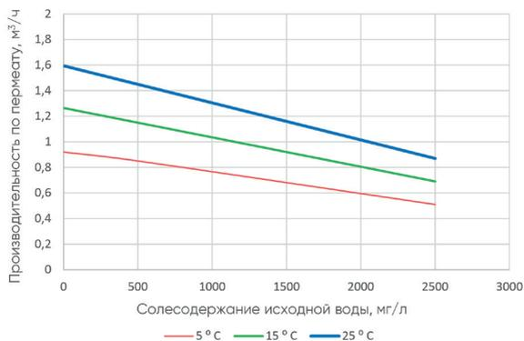
Расчетный график зависимости производительности одной мембраны XLP от общего солеосодержания при заданных температурах\*
