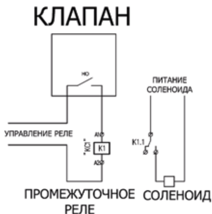
Рис.4 Схема подключения при подаче воды на СОО
