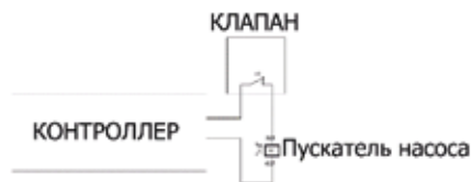
Рис.3 Схема подключения в разрыв питания
