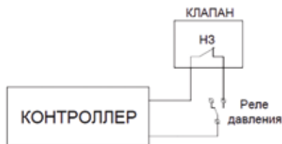
Рис.2 Схема подключения клапана в разрыв сухого хода
