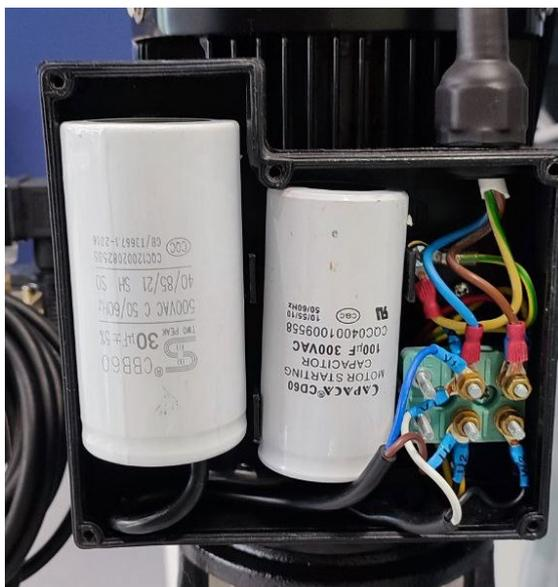
Типы конденсаторов устанавливаемых на двигатели насосов CNP:
