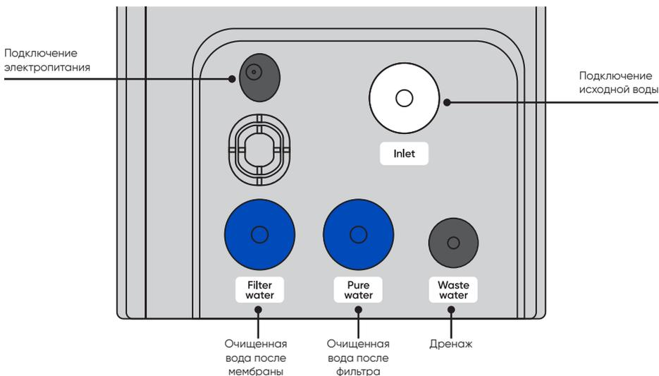
2. Трубку подачи исходной воды (красная) диаметром 3/8" от устройства защиты от протечек LA-2 подключить вместо белой заглушки в порт «Inlet».
