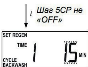
Если на шаге 5СР выбрали проведение регенерации с разной последовательностью стадий, то на дисплее в левом угле появится цифра «1» для всех стадий первой регенерации. Нажатие кнопок «Next», «Вниз» разблокирует настройки в случае их блокировки.
