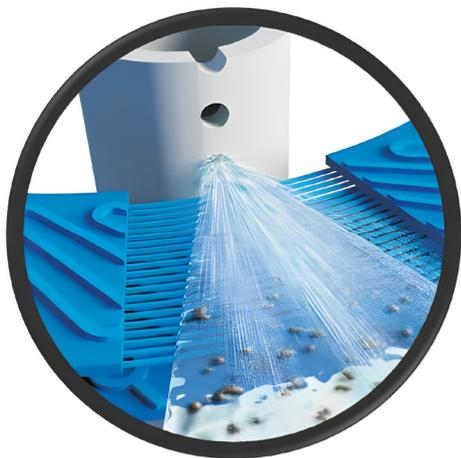
Этот эффект, совместно с возникающим в корпусе фильтра циклонным эффектом, в результате которого одно кольцо вращается относительно другого, практически полностью удаляет загрязнения с колец за короткий промежуток времени, расходуя при этом очень малое количество воды в результате очищающего воздействия центробежной силы и воды обратной промывки. Как следствие – происходит быстрый возврат оборудования в состояние фильтрации.
