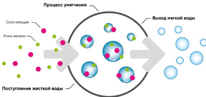
Благодаря фильтрующим свойствам и особенностям каждого компонента Ferosoft обеспечивает одновременное удаление из воды органики, растворённого и коллоидного железа, а также марганца и солей жесткости. При этом количественное соотношение каждого компонента в фильтрующем материале объясняется его функциональной направленностью и способностью к поглощению того или иного загрязнения.
