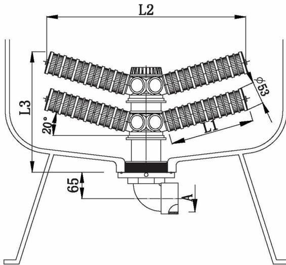
外管连接方式可选：1、弯头 2、直接 3、活接由令
