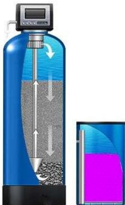
2. Фильтры засыпного типа с реагентной (химической) регенерацией фильтрующей среды.
