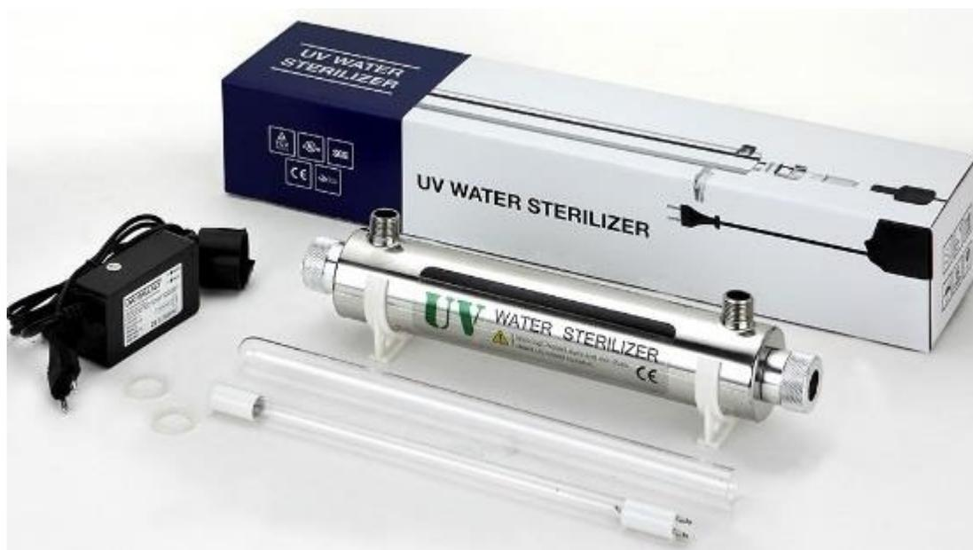
Ультрафиолетовые стерилизаторы производства фирмы *STERILIZER* (Китай). Предназначены для обеззараживания чистой водопроводной воды, не содержащей взвешенных веществ. Корпуса выполнены из нержавеющей стали SS304. В качестве источников излучения, используются кварцевые лампы марки *Philips*.
