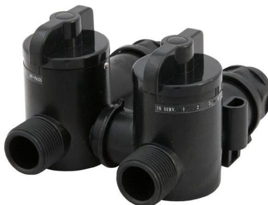
**Байпасный клапан Runxin** - является отличным дополнением для клапанов автоматического управления умягчительной колонны. Данный механизм позволяет регулировать уровень жесткости очищаемой воды путем добавления (подмешивания) в нее небольшого количества исходной воды.
