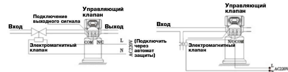
Подключение электромагнитного клапана на входе
