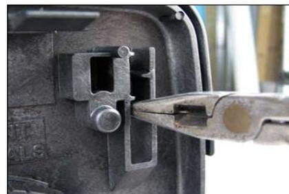
4.5 Проденьте кабель двигателя байпасного клапана через прямоугольное отверстие на задней стенке управляющего клапана и подключите к двухконтактному разъёму «DRIVE» на электронной плате управляющего клапана.
