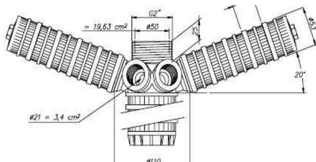
Закрывать верхнее отверстие в водоподъемной трубопроводе сверху плотной пробкой из любого твердого материала так, чтобы ни при каких условиях эта пробка не могла провалиться внутрь корпуса и вертикального коллектора. В противном случае это приведет к полному выходу из строя многоходового клапана блока управления.
