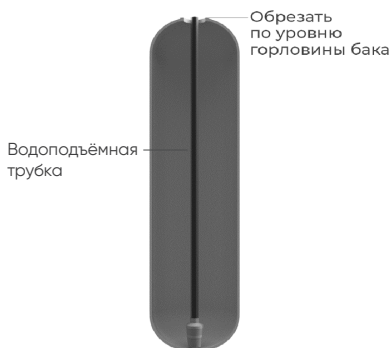
Обрезка водоподъемной трубы
