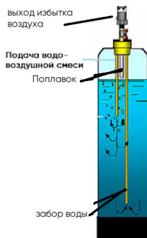
Принцип работы аэратора с оголовком 96-110
